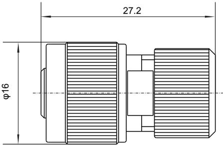
适合配接绝缘层外径为Φ6.5-Φ7, 芯线直径为Φ1.8的高压电缆。
